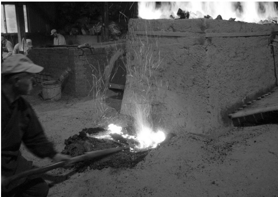
操業初期段階のノロの排出
